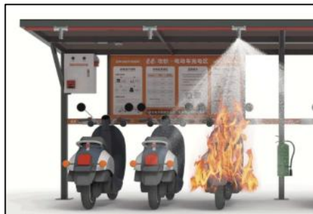
图7. 简易喷淋系统示意图 (出处:网易订阅「电动自行车室外充电桩消防设备整体解决方案」)
